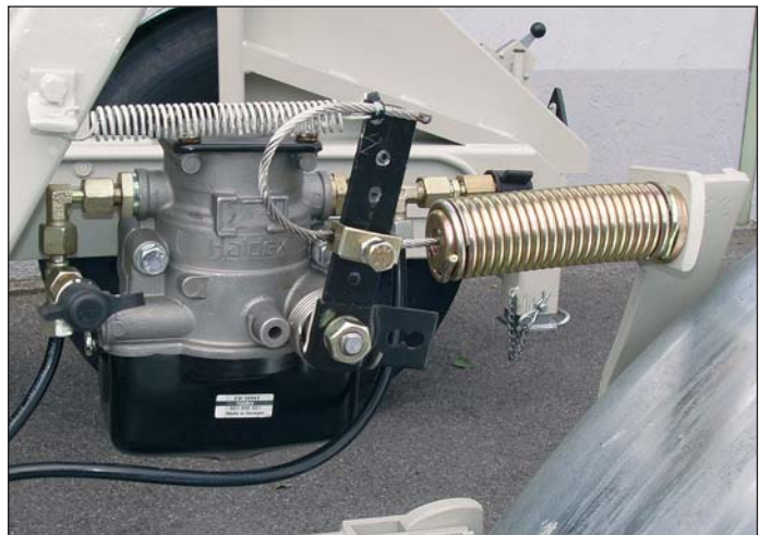
ALB Automatisch lastabhängiger Bremskraftregler (Steuerventil) Automatic load-dependent braking system (control valve) Système de correction automatique du freinage en fonction de la charge (vanne pilote) Regulador de la fuerza de frenado automáticamente dependiente de la carga (valvula de control)
