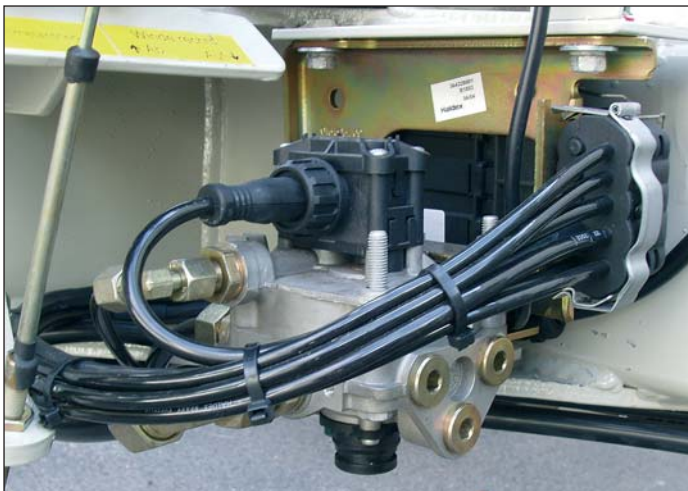
ABS Anti-Blockier-System (Kontrolleinheit) Anti blocking system (control unit) Système anti-blocage (unité de contrôle) Dispositivo antibloqueo (unidad de control)
