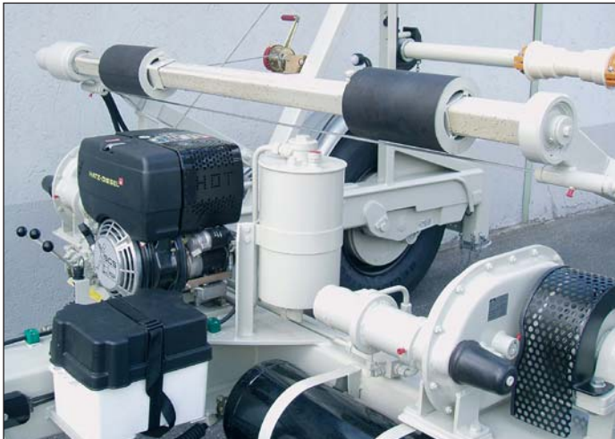
MWT/MHT Hydraulischer Antrieb der Winden oder Hubzylinder und Kabeltrommel durch Benzin- oder Dieselmotor. Hydraulic operation of winch/lifting cylinder and cable-drum by petrol or diesel motor. Entrainement hydraulique des treuils/des vérins et du touret par moteur à essence ou moteur diesel. Accionamiento hidráulico del torno/de los cilindros elevadores y tambor para cable a través del motor de gasolina o diesel.
